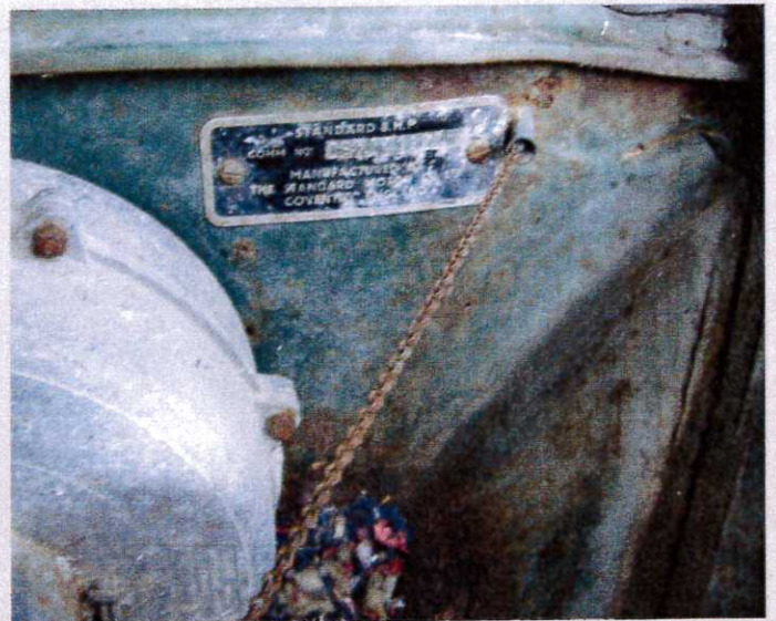
IDENTIFIKASJONSSKILTET: Chassisnummeret er godt leselig til: CS 7271 LDL. Fire skruer tyder på at det kan ha stått et "Kambo" skilt litt lenger ned. Til venstre ser vi litt av det store viftetehuset for varmeapparatet. Kjettingen er for regulering av radiatortgardina.
